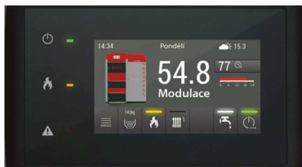
Obr. č. 1 – panel řídicí jednotky IGNEO
