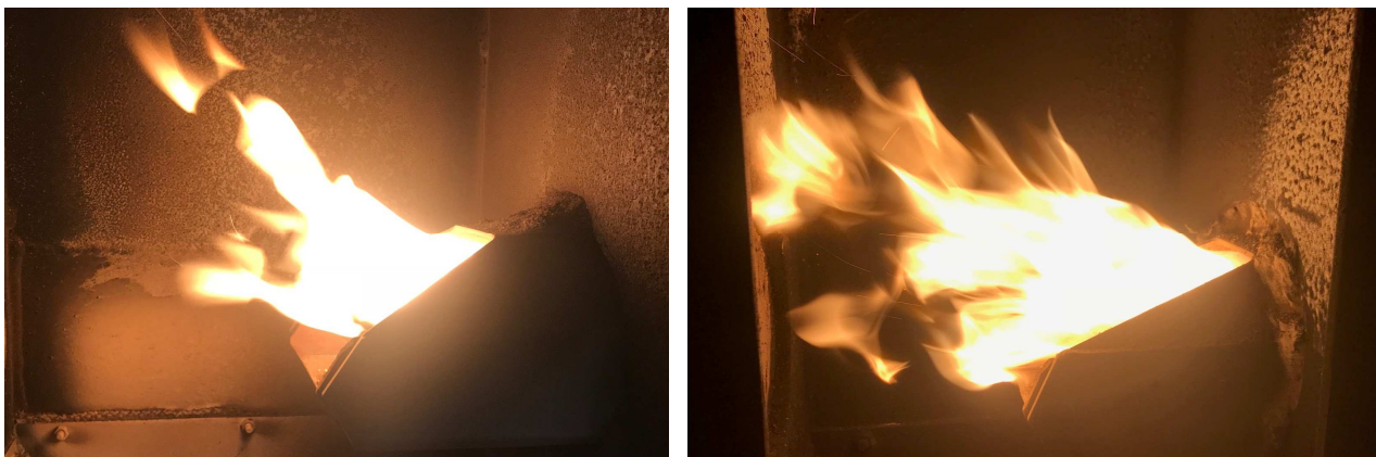
Obr. č. 37 – Tvar plamene – menší výkon vlevo a vyšší výkon vpravo
