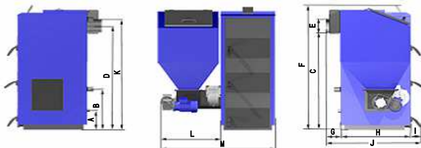
Wymiary montażowe kotłów OGNIWO EKO PLUS
