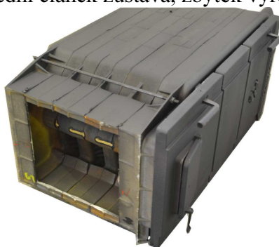
obr. č. 2 - vyřezání kotle
