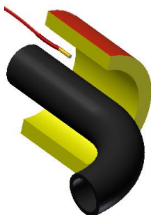
Obrázek číslo 3 Montáž čidel teploty
