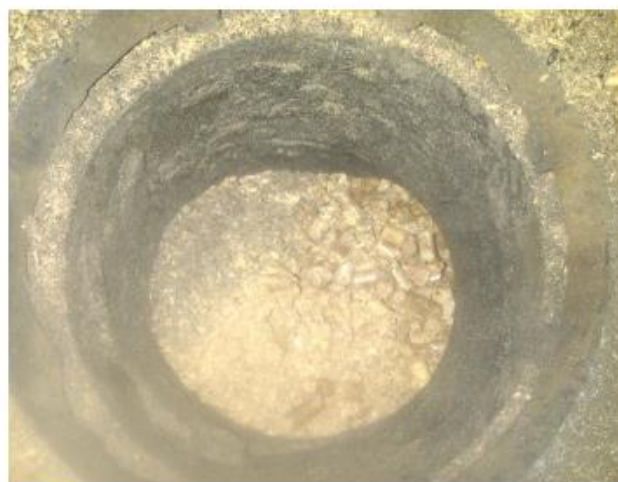
Obrázek číslo 15 Retortový hořák po vyčištění ze zbytků po spalování (spečenců) - pohled na koleno retorty shora.
